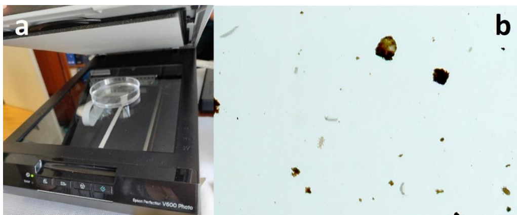
Slika 12. a – Fotografija uzorka s ekstrahiranim organizmima mezofaune postavljenim za skeniranje na skeneru EPSON Perfection V600; b – fotografija uvećane slike skeniranog uzorka s jednikama skupina skokuna i grinja.
