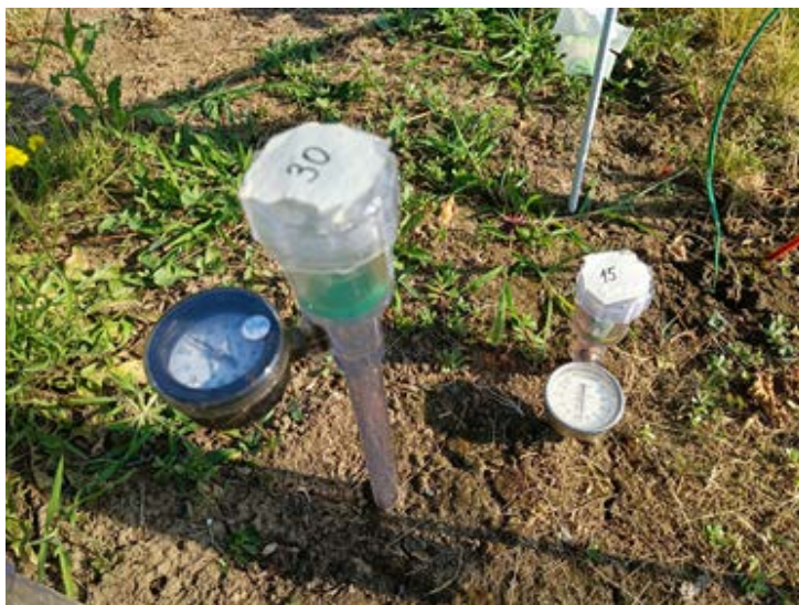
Slika 4. Tenziometar za mjerenje vodnog potencijala
