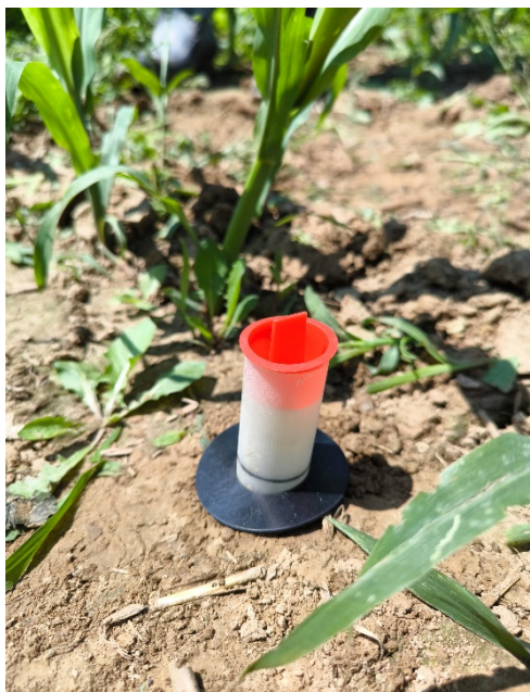
Slika 3. Pristupna cijev za senzor za mjerenje vlažnosti tla
