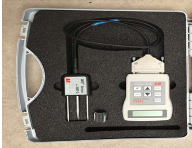
Slika 2. Senzor za mjerenje vlažnosti tla u zaštićenom prostoru
